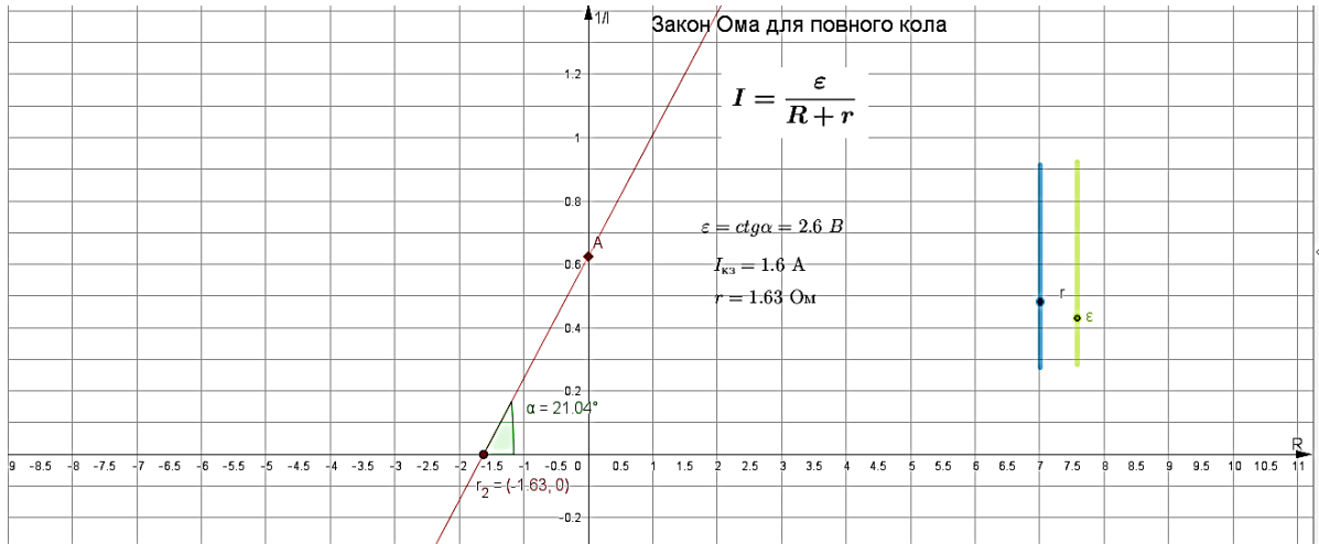
Рис. 2.7. Перевірка виконання закону Ома для повного кола з використанням програмного засобу GeoGebra
