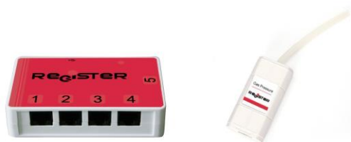
Рис. E.11.2. Реєстратор та датчик тиску цифрової лабораторії Register
